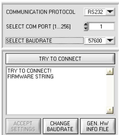
Unter **SELECT BAUDRATE** kann jetzt eine neue Baudrate ausgewählt werden. Durch Drücken von **CHANGE BAUDRATE** wird die neue Baudrate zum Sensor übertragen.
