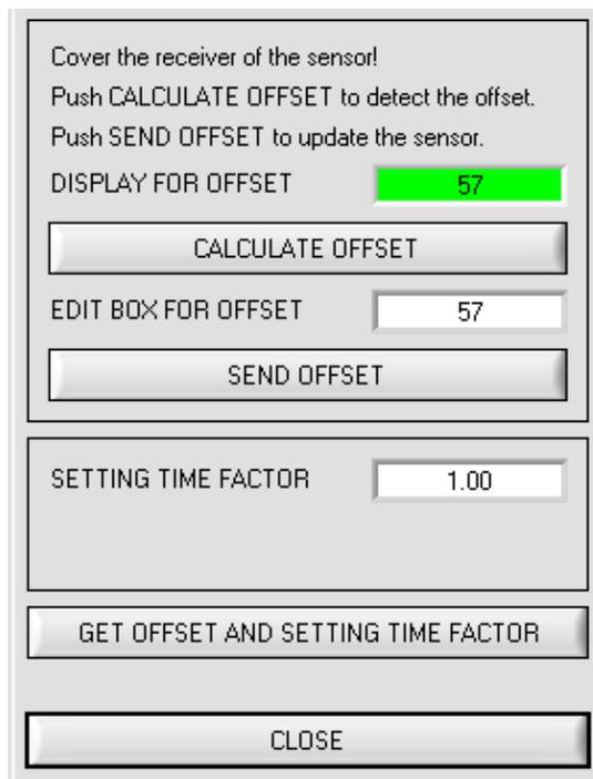
Um zur Offsetkalibrierung zu gelangen, muss in der Registerkarte **PARA** ein Doppelklick mit der rechten Maustaste links neben **INTEGRAL** durchgeführt werden
